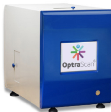
OS-FLi - модель для флуоресцентного сканирования и сканирования в светлом поле (15 стёкол)
