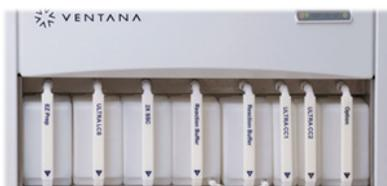
Для растворов, используемых в большом количестве (растворы для депарафинизации, демаскировки, промывки, денатурации при гибридизации, жидкого покровного стекла) выделен специальный модуль буферных растворов.
