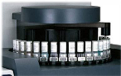
Антитела, системы детекции, ферменты, контрастирующие и амплифицирующие растворы расфасованы в специальные пластиковые диспенсеры. Нанесение реактивов на препарат происходит непосредственно из дозирующего носика диспенсера с помощью молоточка, ударяющего по верхней части диспенсера, без каких-либо дополнительных систем переноса. Это полностью устраняет контаминацию между реактивами и сокращает время работы.
